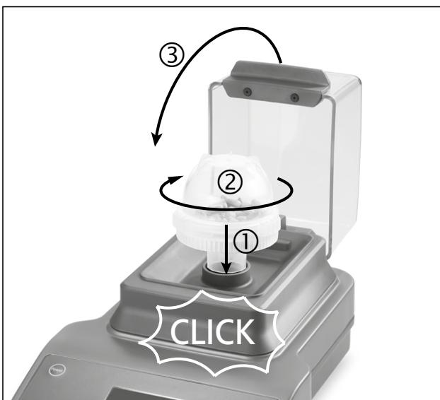
**注記:**粉碎チューブは反時計回りにねじって取り外します。「カチッ」と音がすると、粉碎チューブが差し込み連結部から外れます。
