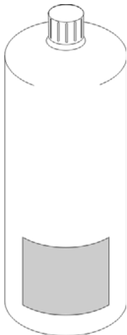
Bild 3 Prov-ID-etikett för en provflaska
