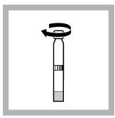
**3.** Screw a grey **DosiCap C** on the cuvette.
